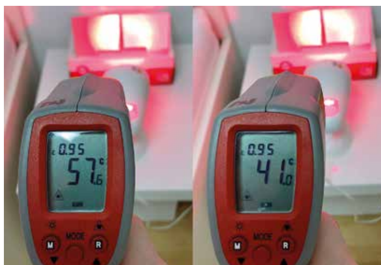
9 Messung der Temperatur beider Blechstücke mittels Laserthermometer
