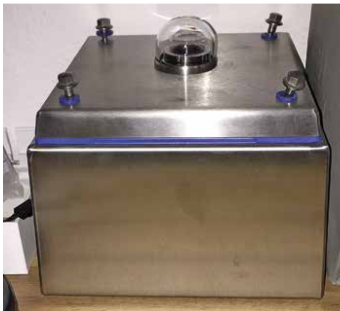
2 Oben: Das Gehäuse der All-Sky-Kamera mit Kuppel
