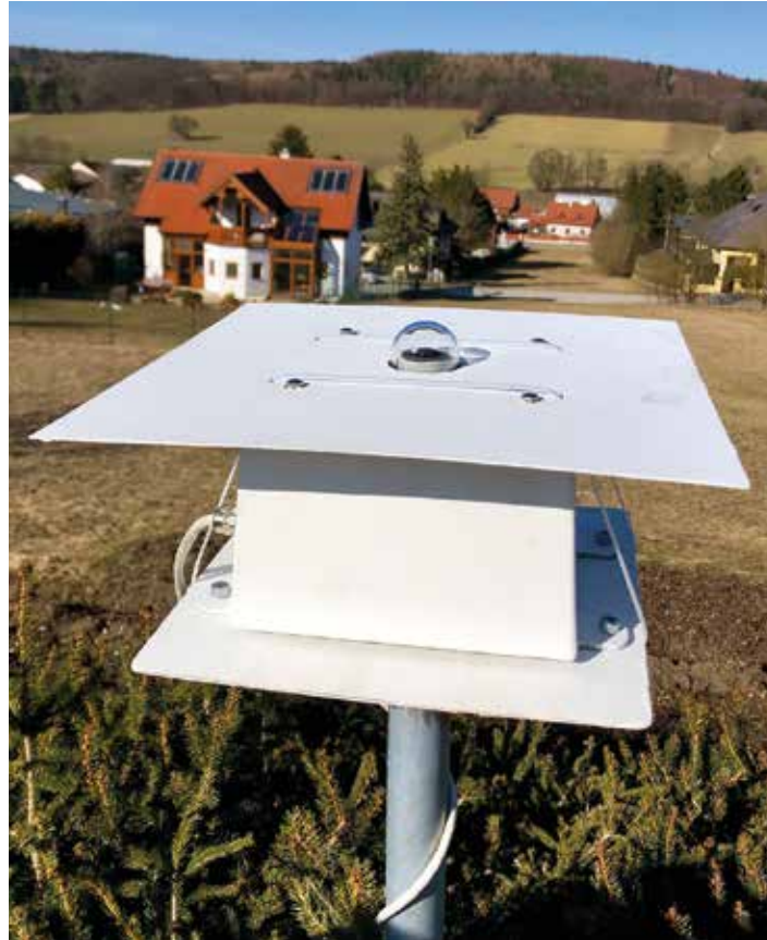
1 Die montierte All-Sky-Kamera an der Sternwarte
