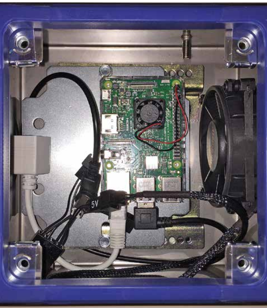
4 Einige Komponenten im Gehäuse (Lüfter, Raspberry, PoE-Injektor). Die Kamera würde sich in der Bildmitte befinden.
